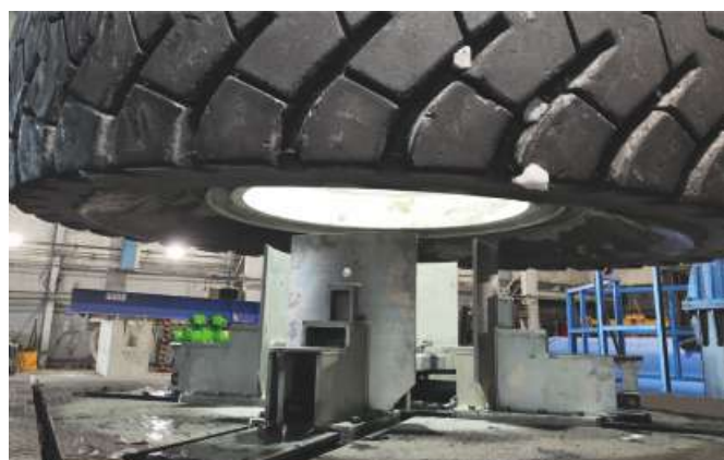
Установка колеса на опорные щеки
