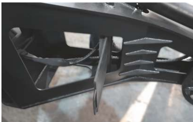
Механизм от опрокидывания колеса «KG3800»
