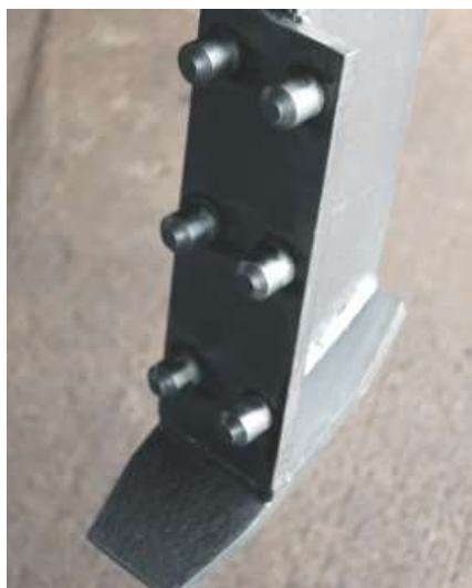
Часть захвата для надежной фиксации колеса
