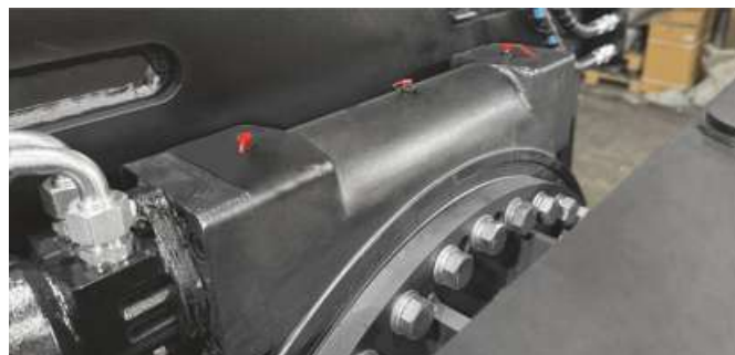
Гидравлический редуктор поворотного механизма колесосъемника
