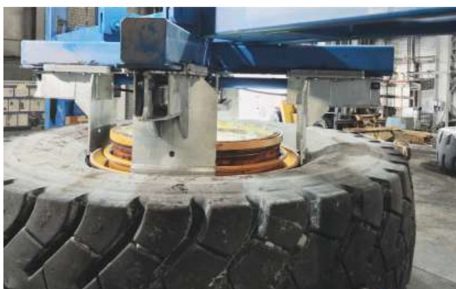
Процесс демонтажа шины крупногабаритного колеса
