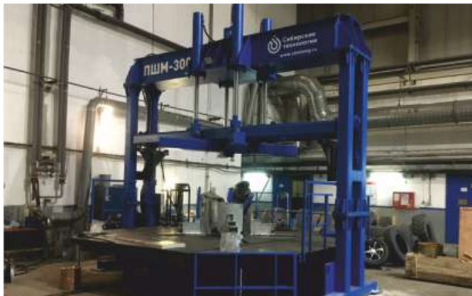
Шиномонтажный стенд (общий вид)
