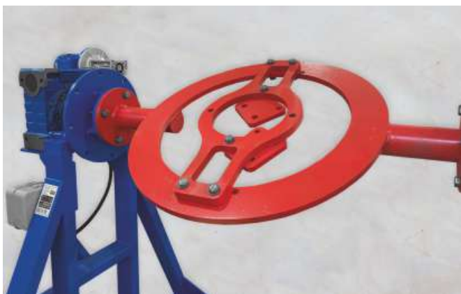
Место под крепление редуктора главной передачи (заднего моста) или дифференциала
