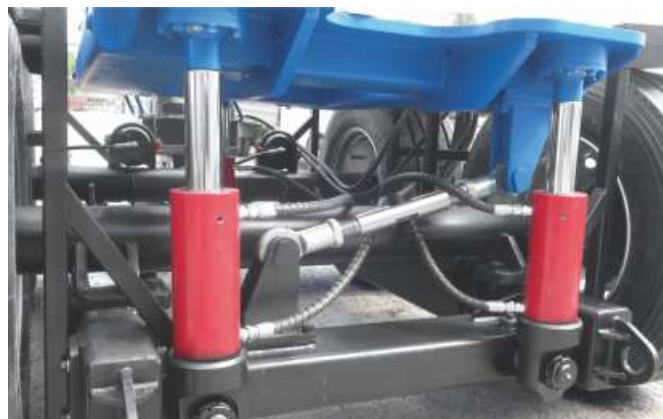
Гидроцилиндры для поднятия подъемного стола
