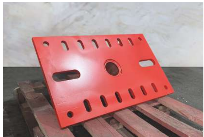
Переходная плита для передней подвески карьерного самосвала Caterpillar
