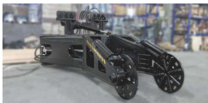
Шинный манипулятор со сведенными захватами
