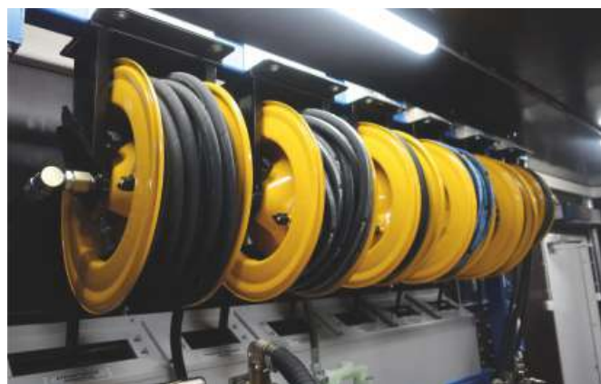
Расположение катушек для 40-ка футовых контейнеров
