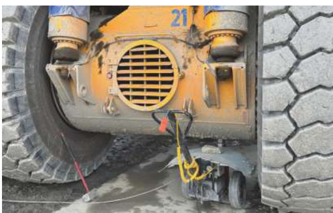
Прорезиненная ручка для удобства при перемещении домкрата
