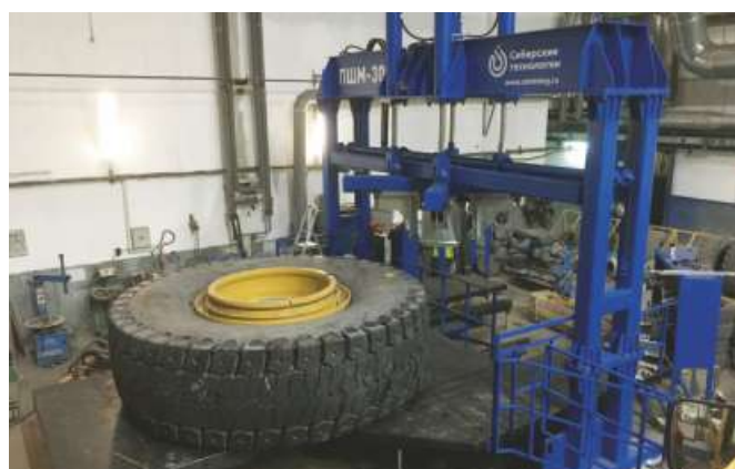
Крупногабаритное колесо на выдвижной раме
