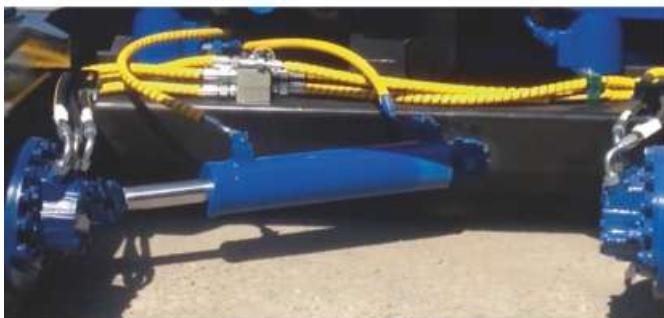
Гидроцилиндр поворотного колеса
