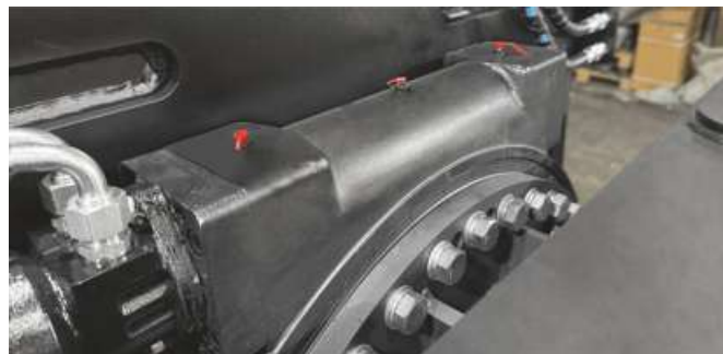
Гидравлический редуктор поворотного механизма колесосъемника
