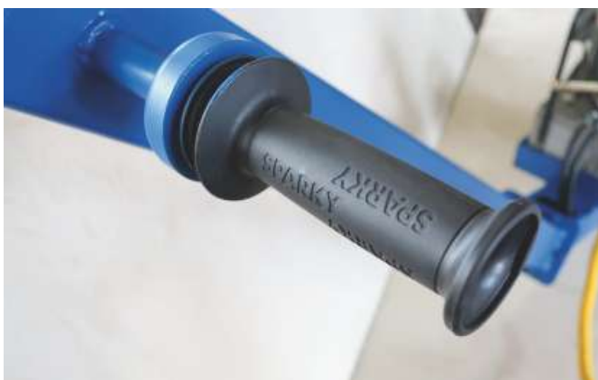
Прорезиненная ручка для удобства при перемещении домкрата
