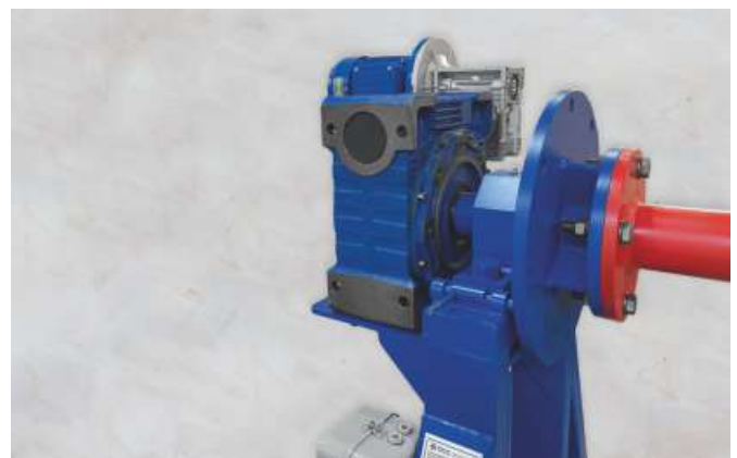
Мотор-редуктор и поворотный механизм
