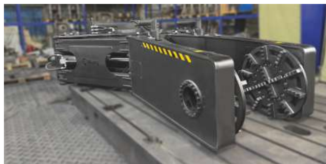
Шинный манипулятор со сведенными захватами
