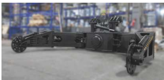
Шинный манипулятор в разведенными захватами
