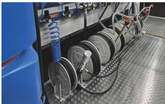
Расположение катушек для 20-ти футовых контейнеров
