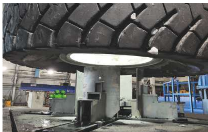
Установка колеса на опорные щеки
