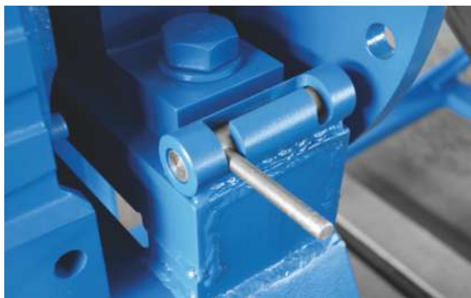
Фиксатор для блокировки поворотного механизма
