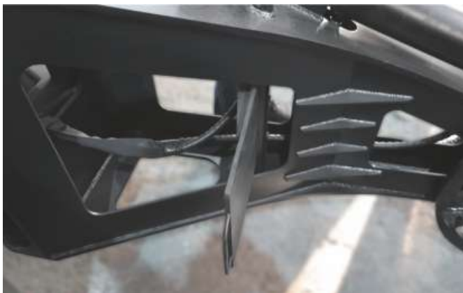
Механизм от опрокидывания колеса «KG3800»
