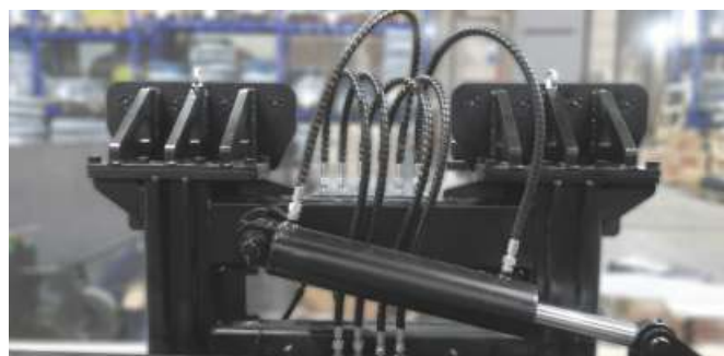
Гидроцилиндр наклона манипулятора
