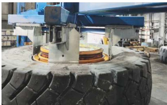
Процесс демонтажа шины крупногабаритного колеса
