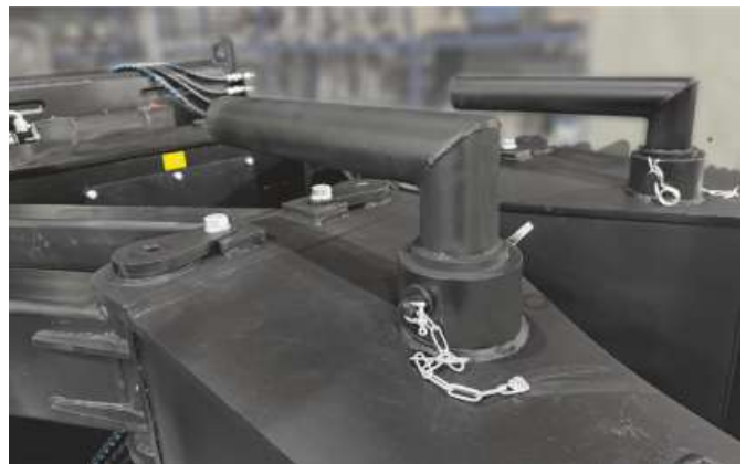
Механизм от опрокидывания колеса «KG3800-RT»
